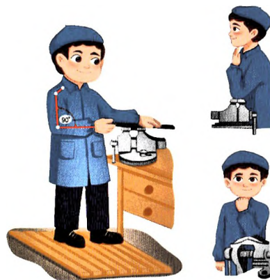
46-rasm. Chilangarlik tiskisini bo'yga mos holda o'rnatish.
